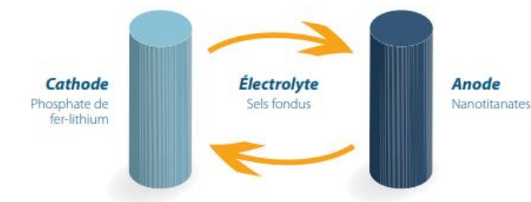
Figure 13. Schéma simplifié d'une batterie avec une cathode en \text{LiFePO}_4
